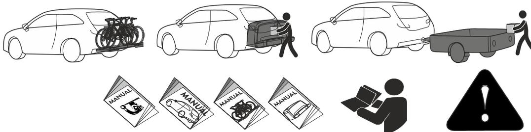
**ВНИМАНИЕ:** при использовании ТСУ для транспортировки багажной системы/багажник (велокрепление, мотоцикл, автобокс, грузовая платформа) необходимо учитывать, что центр масс багажника смещен относительно оси шарового наконечника, что вызывает дополнительные нагрузки. Поэтому общая полная масса багажной системы (багажник + груз) не должна превышать значений, указанных в таблице;
