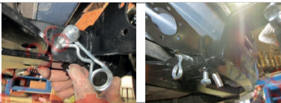
**ШАГ 5.** Установите съёмный шар в сборе и закрепите его пальцем гнутым гальванизированным со шплином пружинным игольчатым. Затяните шар ключом на 38 мм. Установите фиксирующий болт M10x20 снизу, он используется для исключения технологических люфтов съемного шара и только в ненагруженном состоянии! Перед сцепкой болт демонтиrovать!
