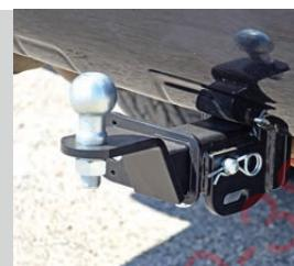
Тип соединения: шаровый; Диаметр сцепного шара: 50 мм.; Масса комплекта ТСУ 09041501: 11,2 кг.
