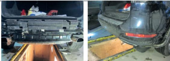
**ШАГ 4.** Установите кронштейн нижний, совместив отверстия в нём с отверстиями в балке ТСУ. Закрепите нижний кронштейн с помощью болтов M12x1,25x120 и гаек M12x1,25 нейлоновых. Установите розетки и зафиксируйте его с помощью гайки M10 через шайбу 10 увеличенную и шайбу 10 гроверную.
