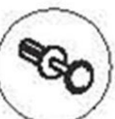
Пластиковый фиксатор Ø8
