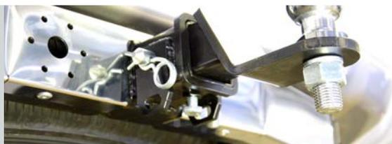
Тип соединения: шаровый; Диаметр сцепного шара: 50 мм.; Масса комплекта ТСУ 21021501: 25,2 кг.
