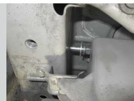
**ШАГ 2.** Установите кронштейны, совместив отверстия кронштейнов с отверстиями крепления штатных проушин в лонжероне. Соедините всё с помощью штатных метизов крепления проушин.
