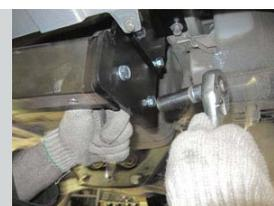
**ШАГ 5.** Установите съемный шар в сборе и закрепите его пальцем гнутым со шплинтом. Зафиксируйте съемный шар болтом М10х20 снизу. Затяните съёмный шар с помощью ключа на 38 мм. Установка завершена.
