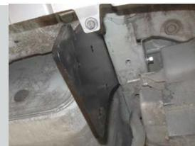
**ШАГ 3.** Для установки фаркопа совместите отверстия в сварном кронштейне с отверстиями боковых кронштейнов и соедините всё с помощью болтов М10х40х1,25, через шайбы М10 увеличенные, шайбы М10 пружинные, гайками М10х1,25.
