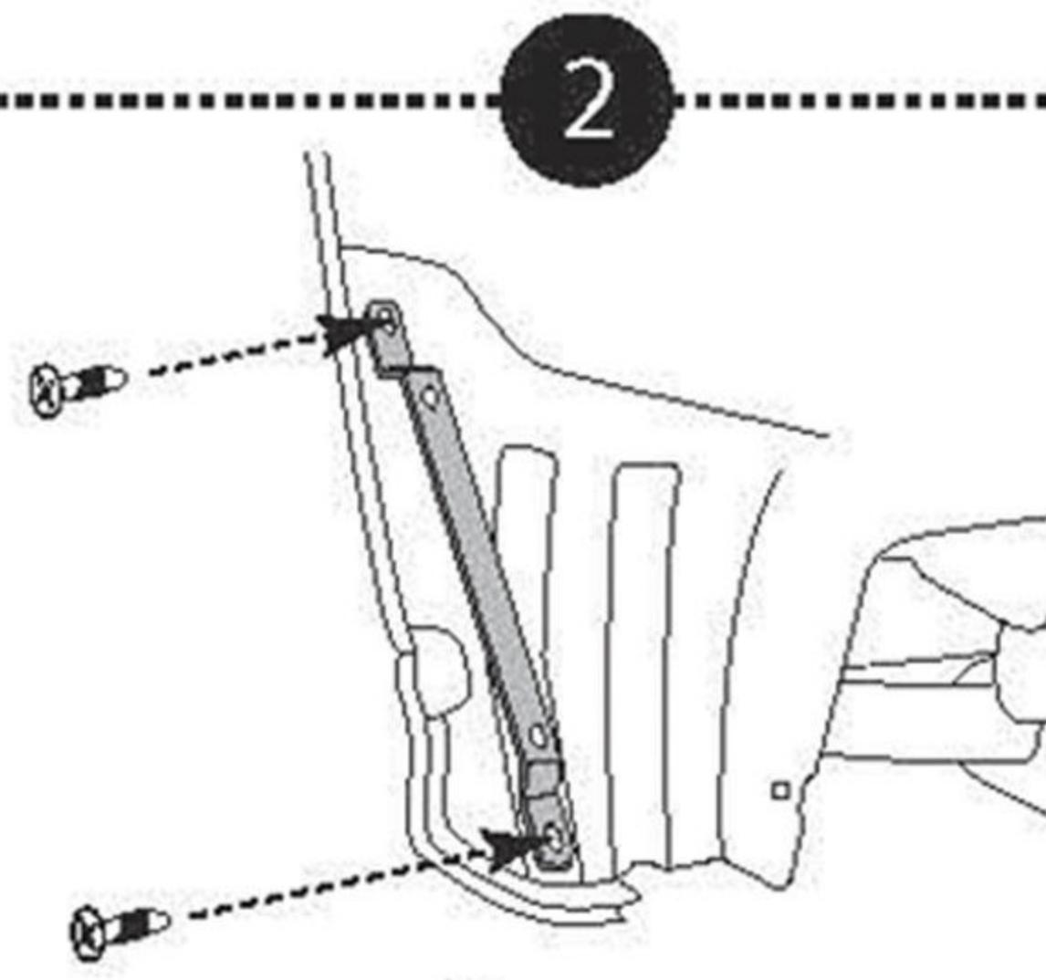
Установить кронштейн из комплекта поставки, зафиксировать штатными саморезами.
