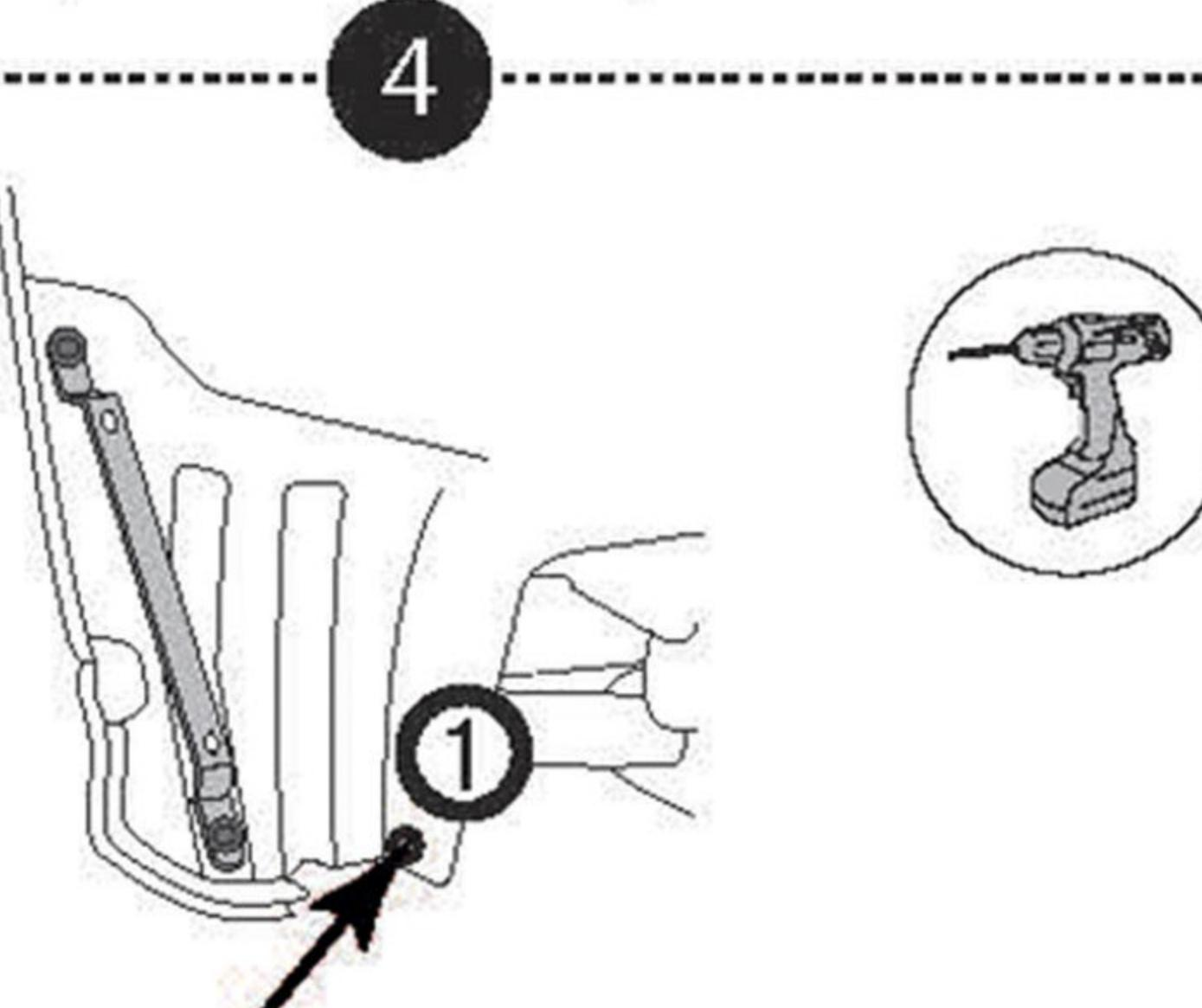
Снять брызговик, в отмеченной точке 1 используя сверло Ø 8 мм просверлите отверстие в подкрылье.
