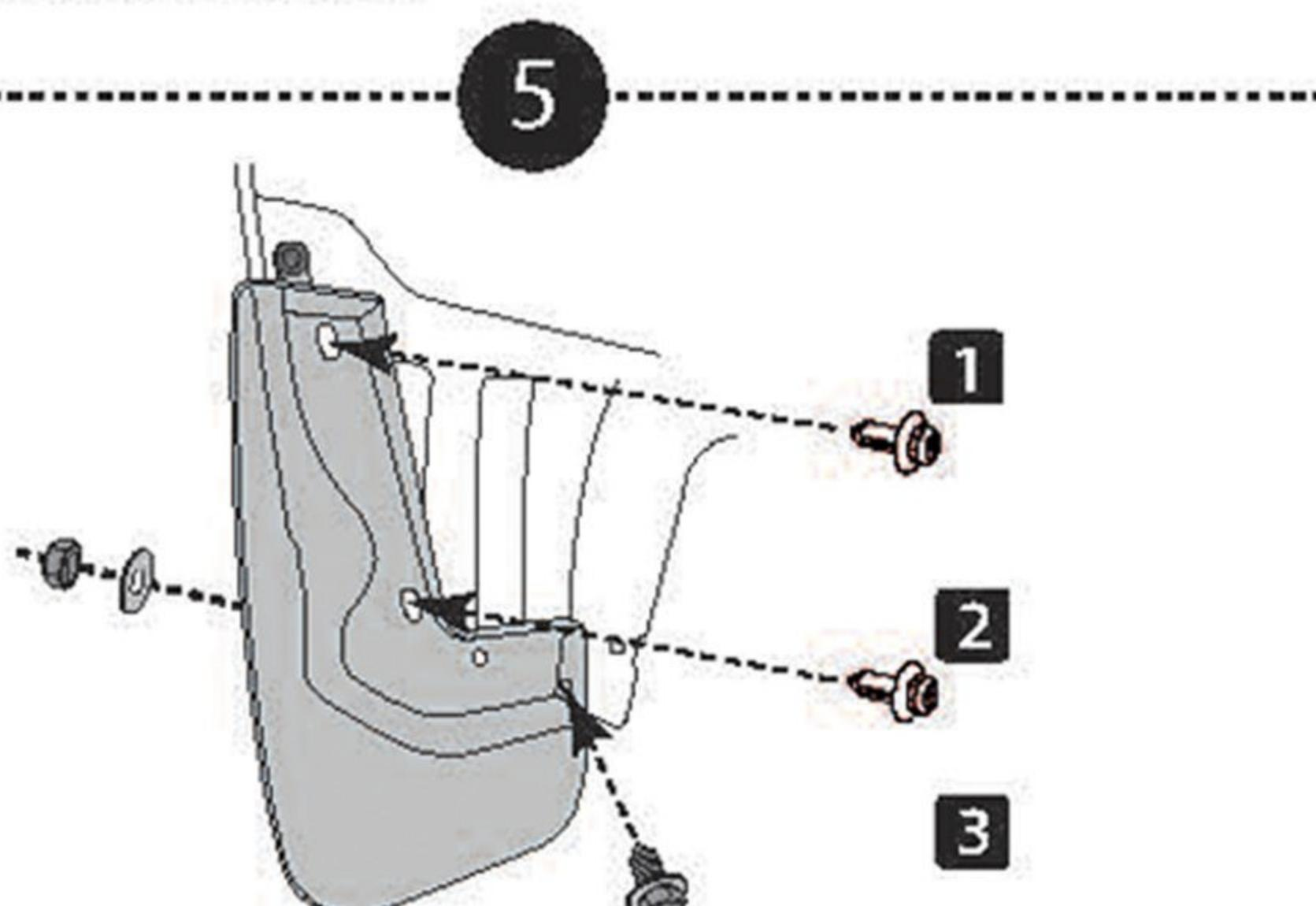
Установить брызговик. В точках 1 и 2 зафиксировать клипсами с резьбой из комплекта поставки. В точку 3 установить винт, гайку и шайбу из комплекта поставки.
