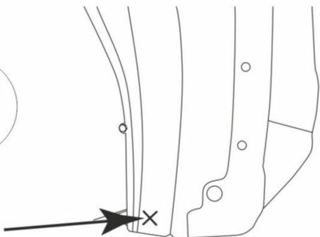
Используя сверло Ø 8 мм, просверлите отверстия в отмеченном месте.
