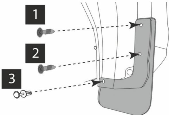
В точках 1 и 2 установите саморезы из комплекта поставки. В точку 3 установите пластиковый фиксатор из комплекта поставки.
