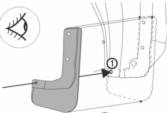
Произведите визуальную примерку, приложив изделие к месту планируемой установки. Согласно точке 1 на брызговике, отметьте место для сверления в колесной арке.
