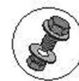
Винт, шайба и гайка
