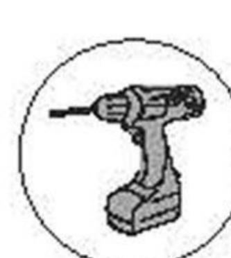
Используя сверло Ø 6 мм, просверлите
