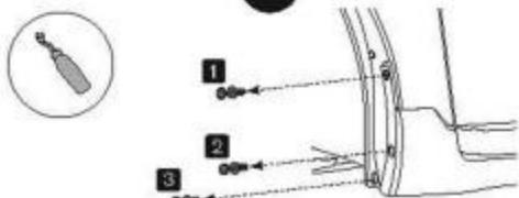
Используя инструмент для демонтажа с вилкой, произведите демонтаж штатных пластиковых фиксаторов в точках 1, 2 и 3.
