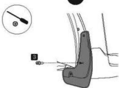
Используя отвертку с крестообразной насадкой, в точке 3 установите пластиковый фиксатор с резьбой, входящий в комплект поставки.
