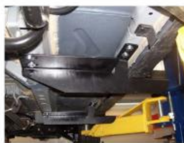
Рис.5 Установка заднего кронштейна
