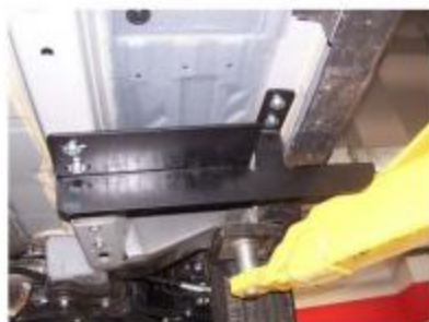
Рис.4 Установка переднего кронштейна
