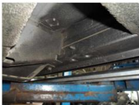
Рис.2 Место установки переднего кронштейна
