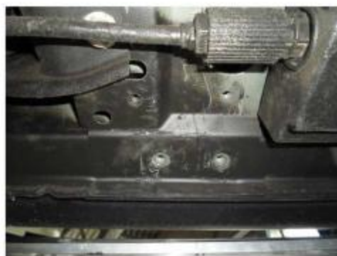
Рис.3 Место установки заднего кронштейна
