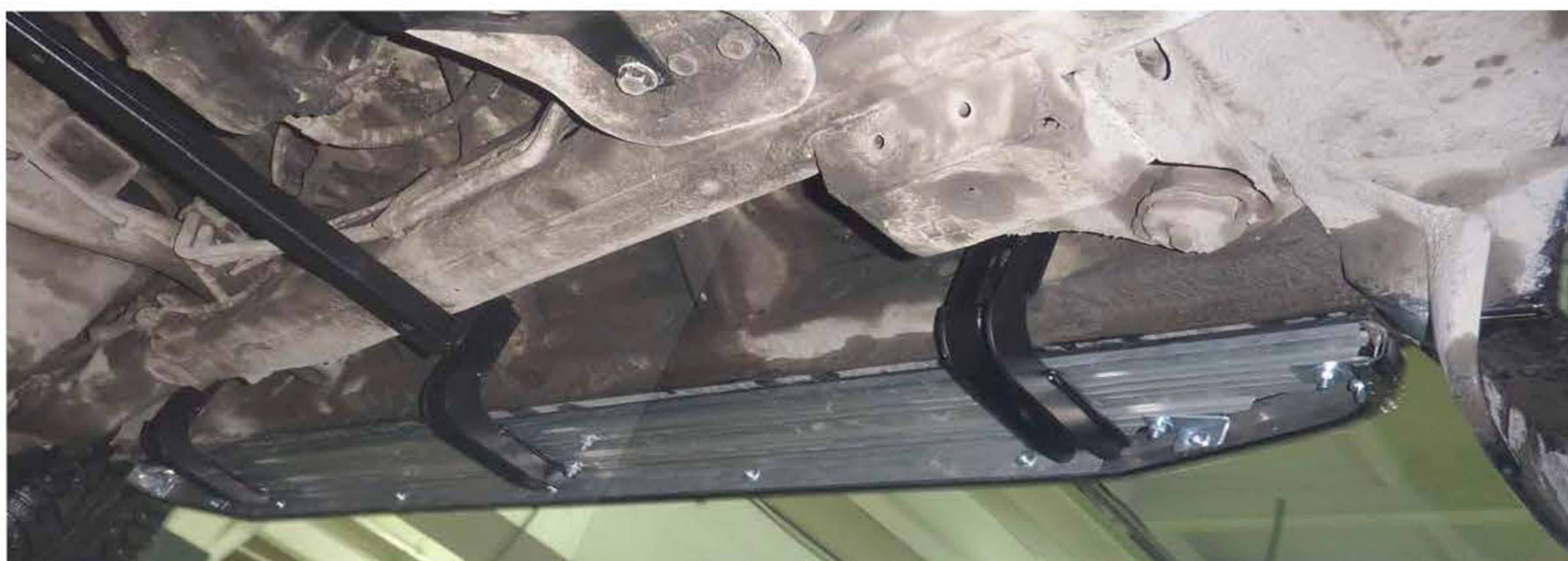
Рис. 4 Вид установленных кронштейнов
