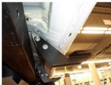
Рис.3 Установка кронштейна в средней части порога автомобиля.
