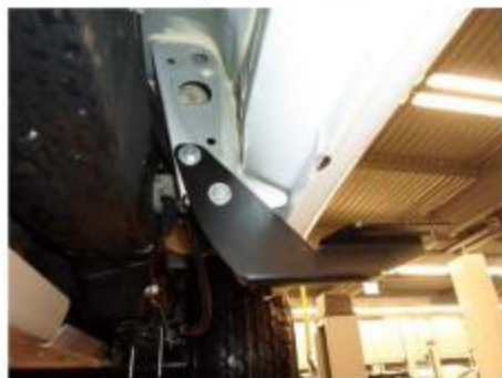
Рис.4 Установка кронштейна в задней части порога автомобиля.
