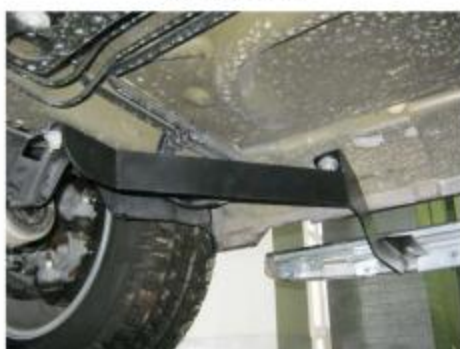
Рис.4 Установка переднего кронштейна.
