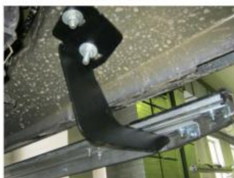
Рис.5 Установка заднего кронштейна.
