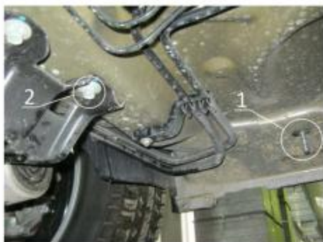
Рис.2 Место крепления переднего кронштейна.
