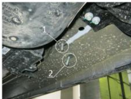
Рис.3 Место крепления заднего кронштейна.
