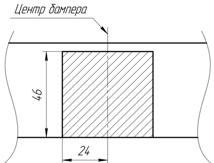
Выполнить вырез на бампере согласно схеме. Затем установить бампер в обратной последовательности.
