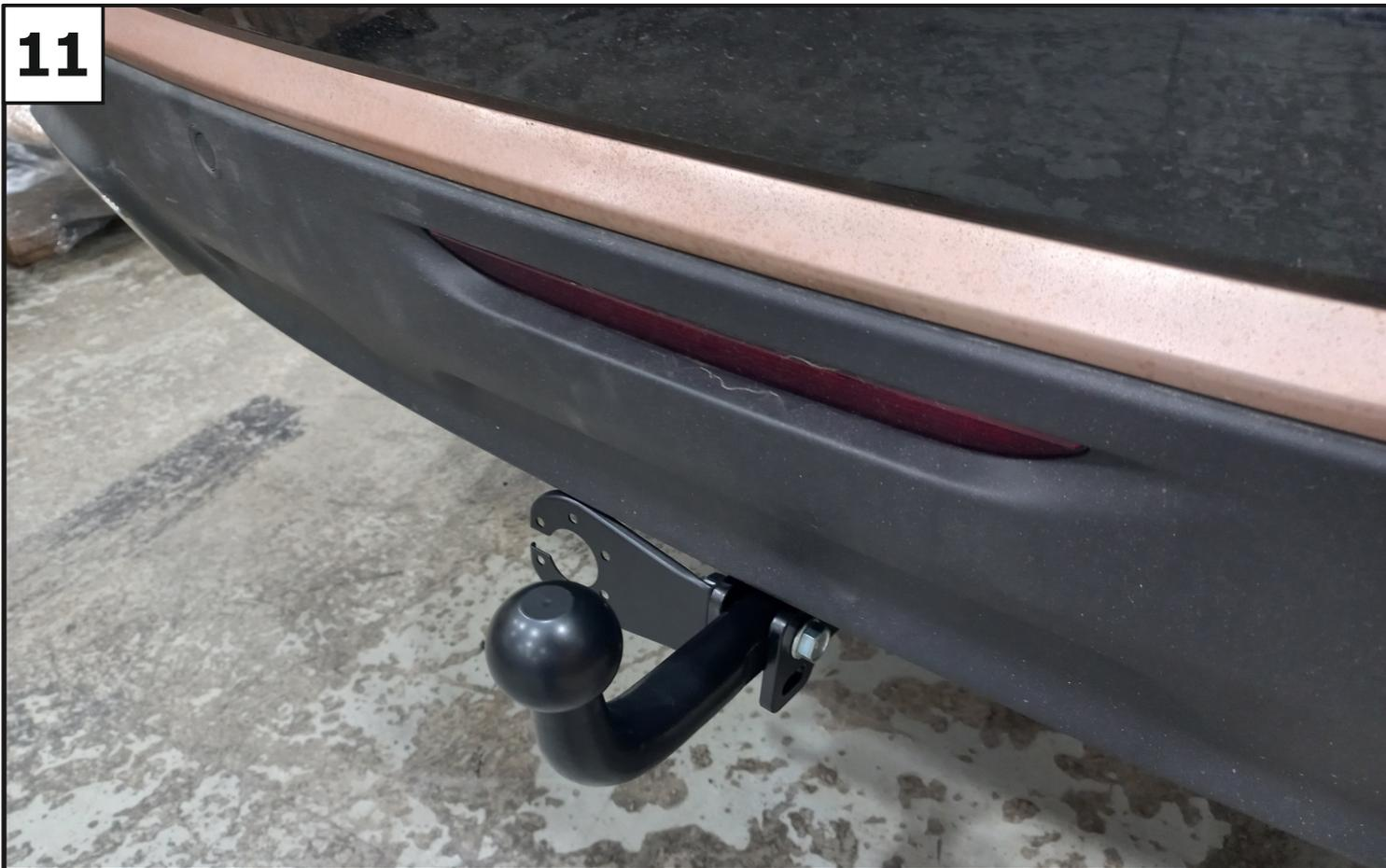
Установить кронштейн под розетку (6) и крюк (7), закрепив с помощью болтов M12x1,25x70 (9), гаек M12x1,25 (10), шайб 12 пружинных (11) и шайб 12 (12).
