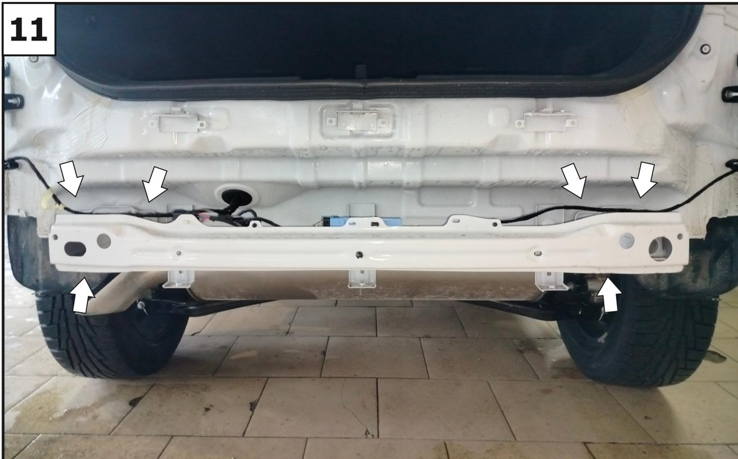
**Открутить заводские гайки крепления усилителя бампера и демонтировать усилитель.**
