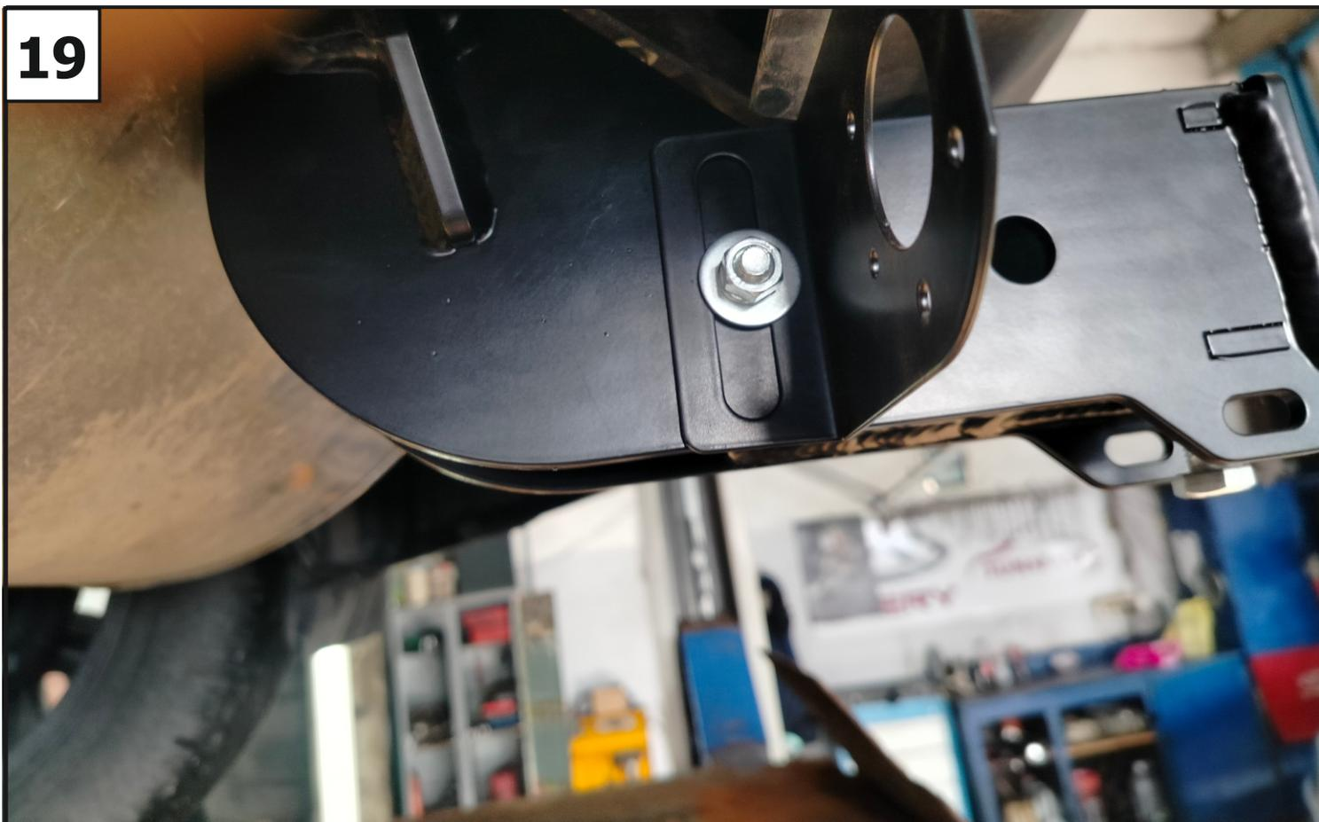
**Установить кронштейн под розетку (9) с помощью болтов M8x80 (9), шайбы 8 (21), шайбы 8 увел. (22), шайбы 8 пружинных (23) и гайки M8 (11).**
