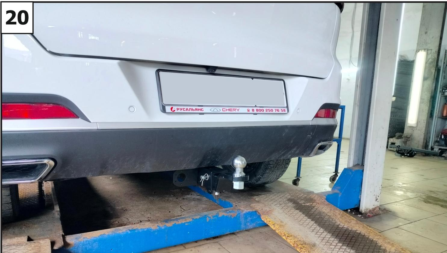
**Установить переходник (5), закрепив с помощью штифта (7) и шплинта (8).
