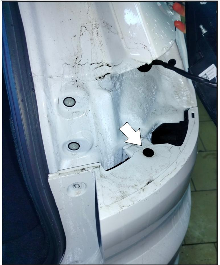
**Выкрутить винты крепления бампера под фонарем с левой и правой части автомобиля и демонтировать бампер.**
