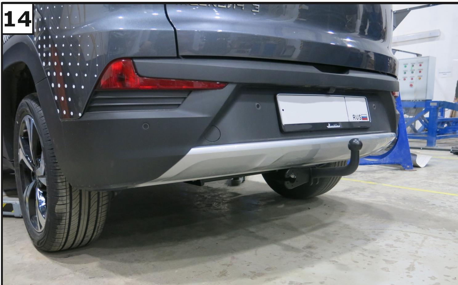
Затянуть все резьбовые соединения. Моменты затяжки: M12=81 Нм.
