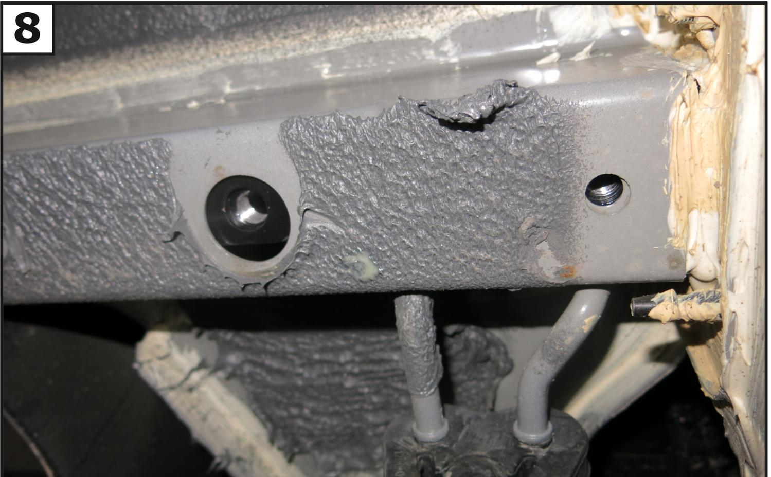
**Затем переместить закладную (4) назад к задней панели, выставив резьбовой частью М10х1,25 сосоно с малым отверстием лонжерона.**
