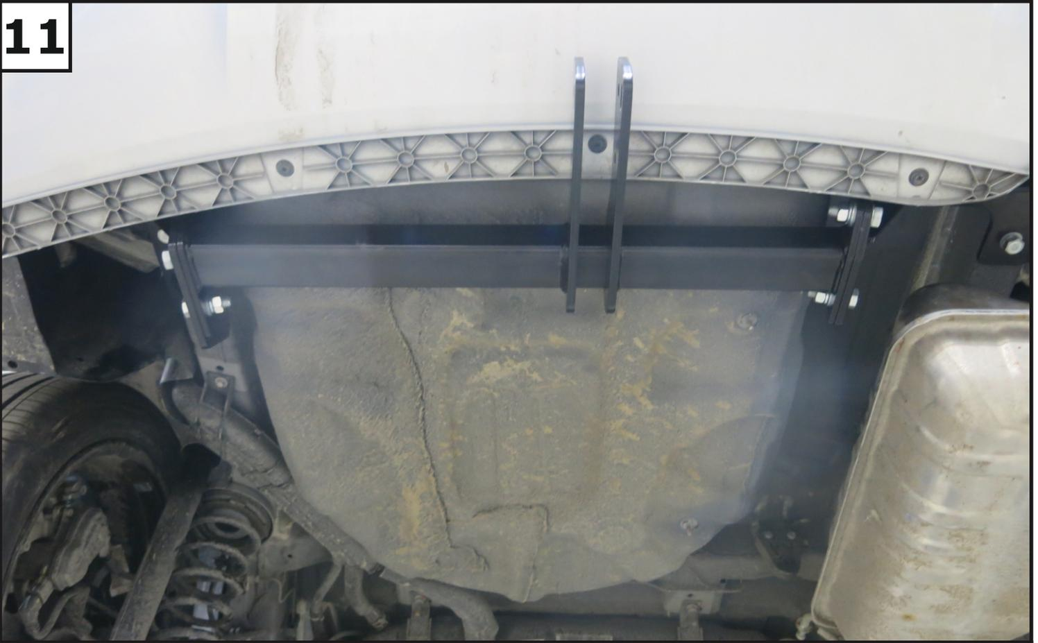
К установленным кронштейнам закрепить балку (1) с помощью болтов М12х1.25х40 (8), гаек М12х1,25 (10), шайб 12 пружинных (13) и шайб 12 увел. (14).
