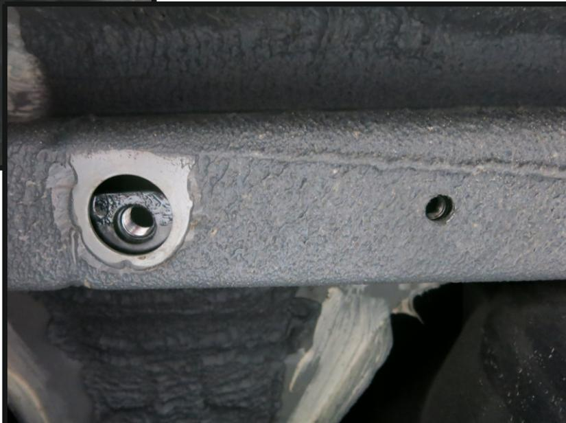
Установить закладную (4) в левый лонжерон через отверстие 30мм и выставить её соосно резьбовой частью М10х1,25 с рассверленным отверстием.
