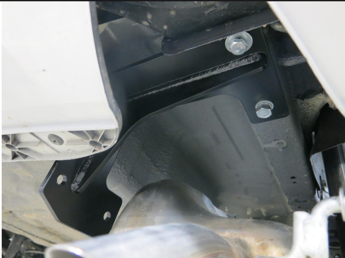
Закрепить правый кронштейн (3) к установленной закладной (4) в правый лонжерон болтом М10х1,25х35 (7) с шайбой 10 пружинных (11), 10 увел. (12) и болтом М12х1,25х40 с шайбой 12 пружинных (13), шайбой 12 (14).
