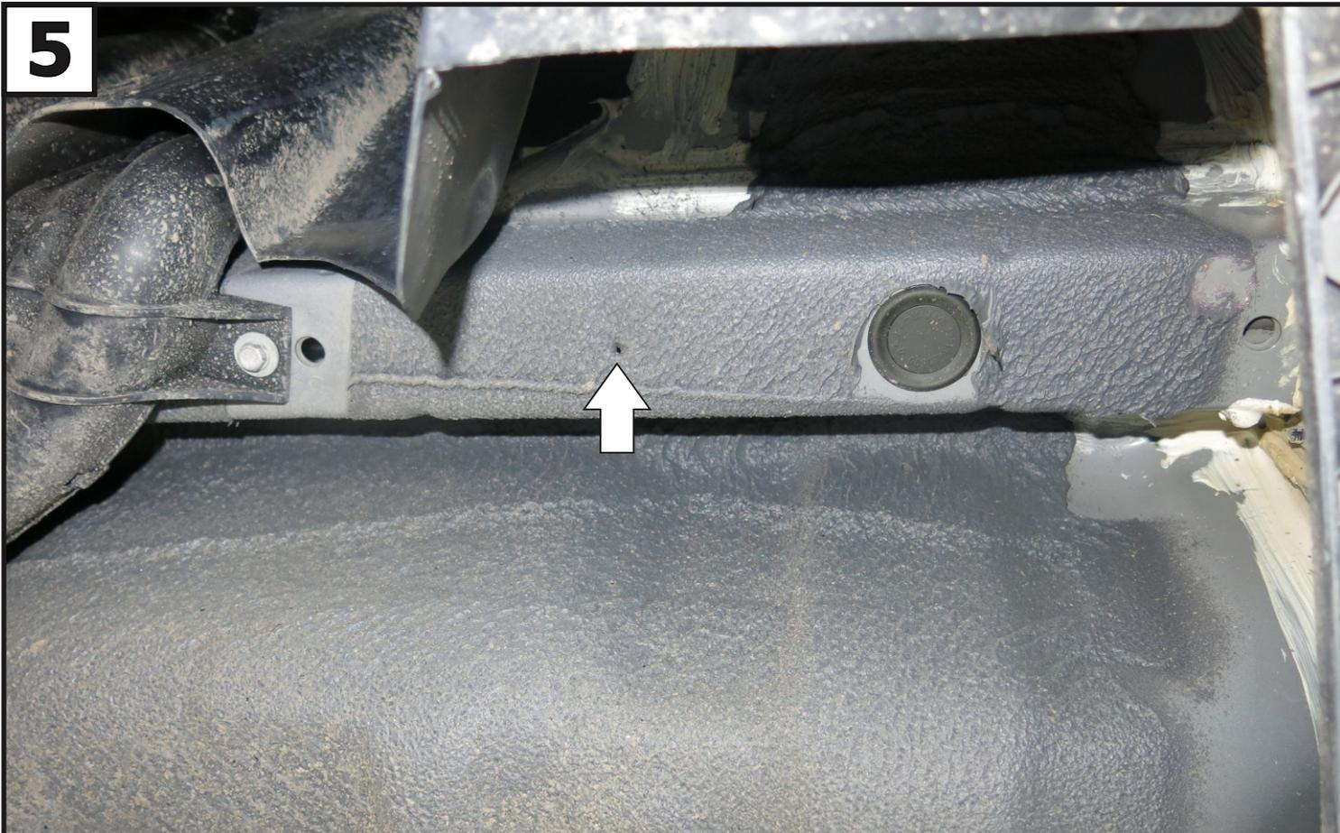
В левом лонжероне рассверлить до 10,5мм третье отверстие от задней панели, которое находится на расстоянии 110 мм от центра большого отверстия.
