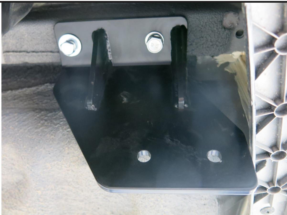
Закрепить левый кронштейн (2) к установленной закладной (4) в левый лонжерон болтом М10х1,25х35 (7) с шайбой 10 пружинных (11), 10 увел. (12) и болтом М12х1,25х40 с шайбой 12 пружинных (13), шайбой 12 (14).
