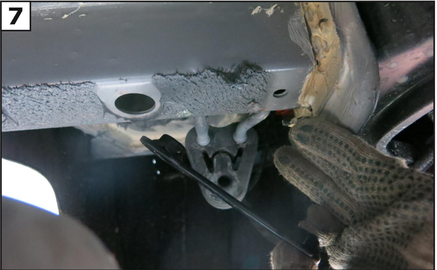
**Установить закладную (4) в правый лонжерон через отверстие 30мм.**
