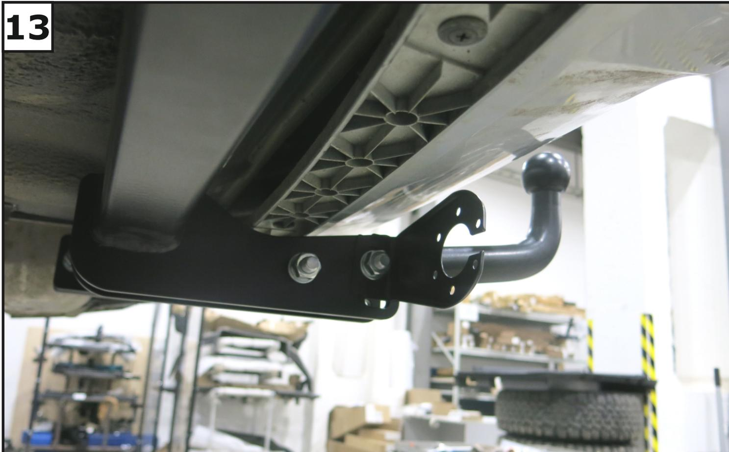
Установить кронштейн под розетку (5) и крюк (6) с помощью болтов M12x1.25x70 (9), шайб 12 пружинных (13), шайб 12 (14) и гаек M12x1.25 (10).
