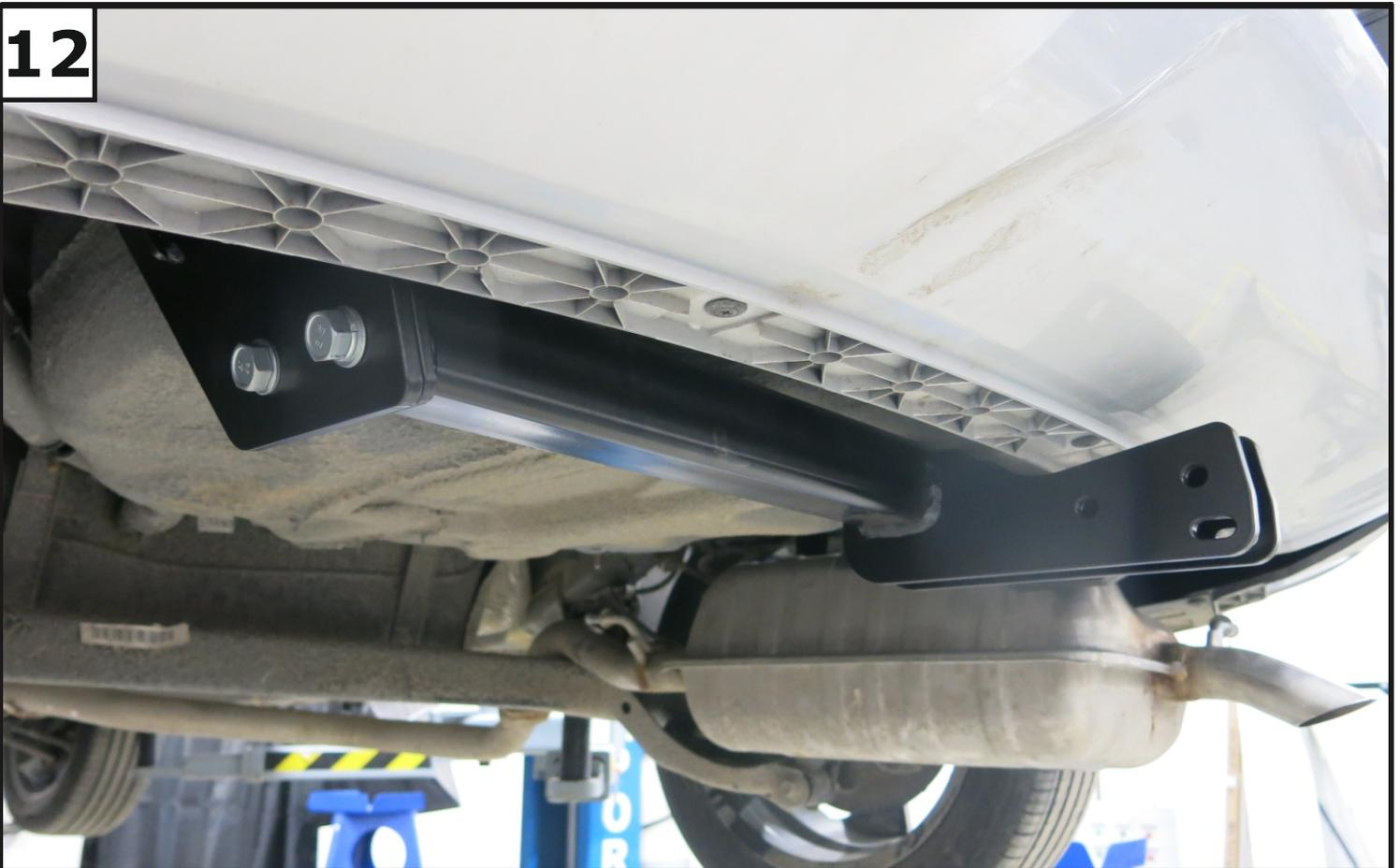
Затянуть все резьбовые соединения - сначала балку с кронштейнами, затем кронштейны к лонжеронам автомобиля. Моменты затяжки: М12=81 Нм, М10=47 Нм.
