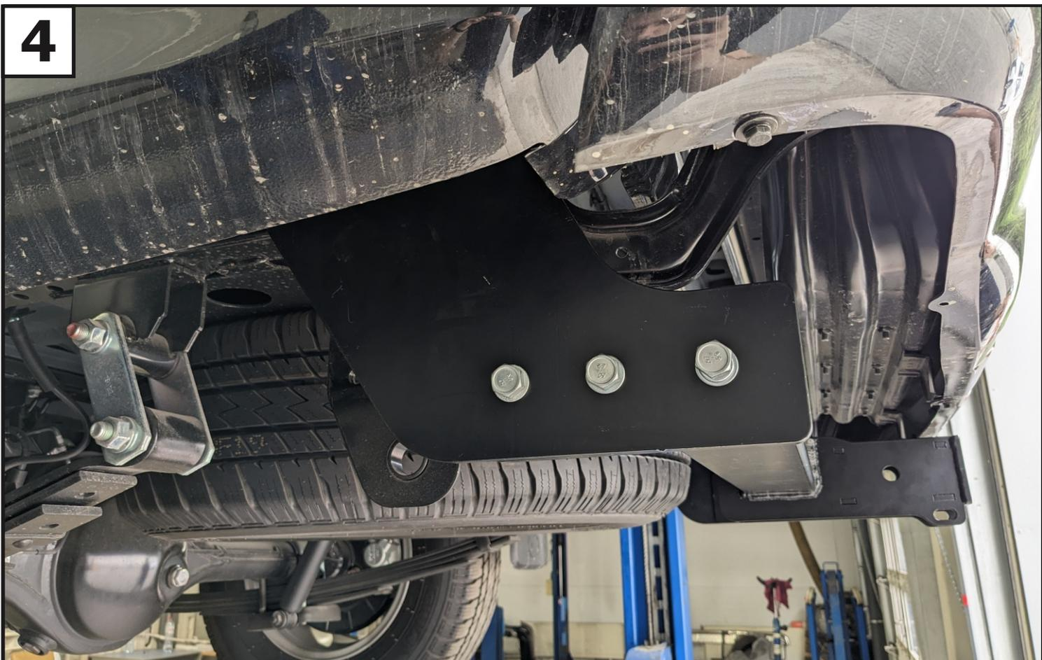
**К установленным кронштейнам (2 и 3) закрепить балку (1) с помощью болтов М12х1,25х40 (11), шайб 12 пружинных (17), шайб 12 (16) и гаек М12х1,25 (13).**
