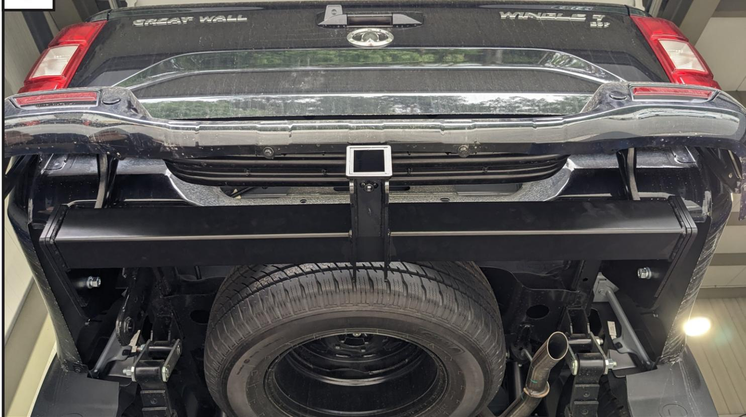
Затянуть все резьбовые соединения — сначала балку с кронштейнами, затем кронштейны с рамой автомобиля. Моменты затяжки: M12=81 Нм.
