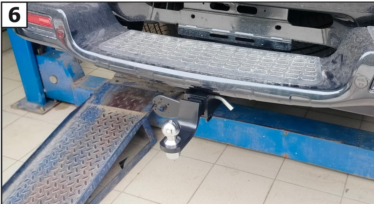
Установить кронштейн под розетку (8) на балку (1) с помощью болта M8x16 (9), шайбы 8 пружинной (14) и шайб 8 увел. (15). Установить переходник (4), закрепив с помощью штифта (6) и шплинта (7). Зафиксировать переходник болтом M10x20 (10) - фиксацию использовать только без нагрузки. Установить на переходник шар (5), закрепив гайкой M24 (18) с шайбой 24 пружинной (19).
