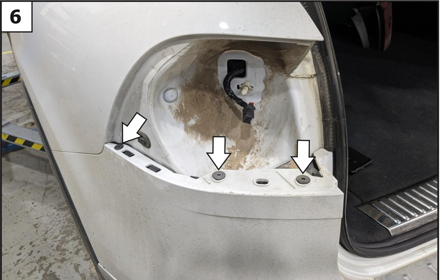
**Снять задние фонари, выкрутить винты и демонтировать клипсы крепления бампера.**
