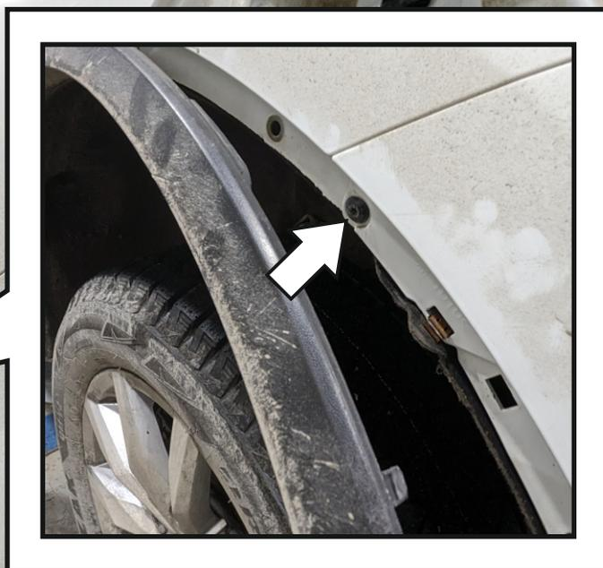
Снять боковую накладку и открутить расположенный под ней винт крепления бампера. С другой стороны аналогично.
