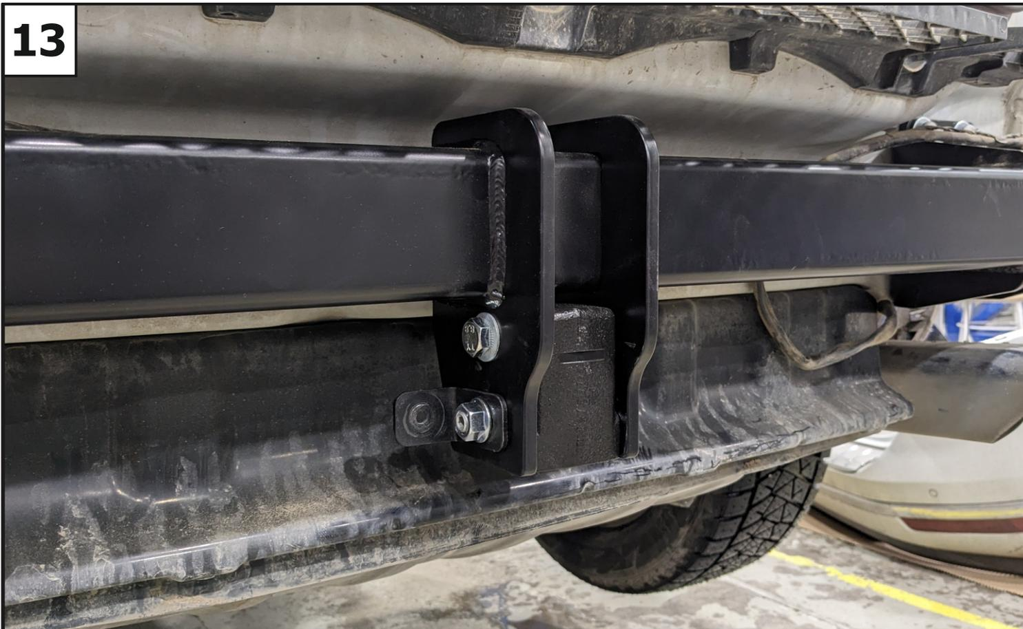
Установить ответную часть быстросъёма и уголок (2) с помощью болта М12х100 (7), шпильки М12х25 (9) и шпильки М12х35 (10), шайбы 12 с насечками (16) и гаек М12 с фланцем (12) (шпильки (9 и 10) закручивать до упора без усилия).
