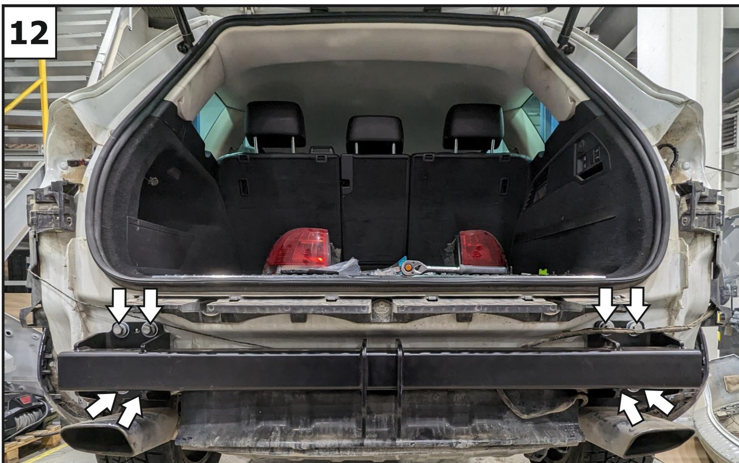
**12** Установить балку (1) на место усилителя бампера, закрепив её с помощью штатных болтов, шайб 12 увеличенных (17) (или шайб 14 (19)) и шайб 12 пружинных (15) (или шайб 14 пружинных (18)). Отрегулировать положение балки относительно центра автомобиля. Затянуть все резьбовые соединения. Момент затяжки:  $M_{12}=81 \text{ Нм}$  ( $M_{14}=126 \text{ Нм}$ ).
