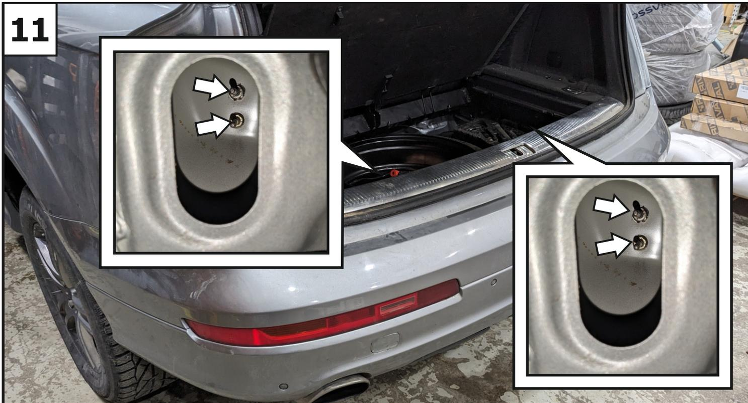
**11** Под полем багажника, со стороны задней панели, открутить гайки. Демонтировать задний бампер, отключив разъемы электропроводки. Демонтировать усилитель бампера. В дальнейшем усилитель не потребуется.
