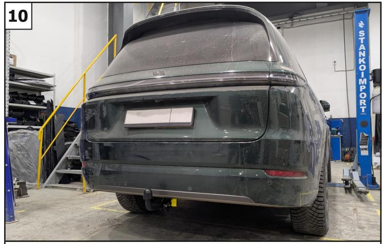
Установить бампер и пыльник в обратной последовательности. Установить вставку быстросъема в ответную часть. Закрепить крюк (5) с помощью винтов M12x45 (10). Затянуть все резьбовые соединения. Момент затяжки: M12=81 Hм.
