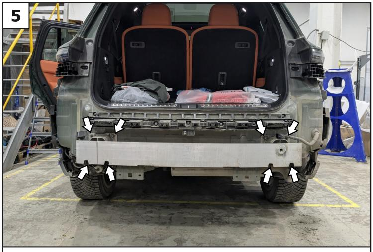
Открутить гайки крепления усилителя и демонтировать усилитель.
