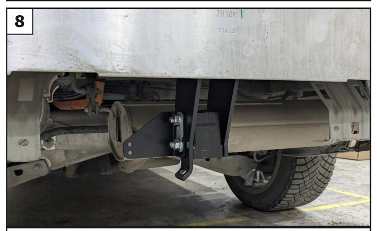
Установить ответную часть быстросъема и кронштейн (2), закрепив с помощью болта M12x100 (11), шпильки M12x25 (8), шпильки M12x35 (9), шайбы 12 с насечками (17) и гаек M12 с фланцем (13). Шпильки (8 и 9) закручивать до упора без усилия.
