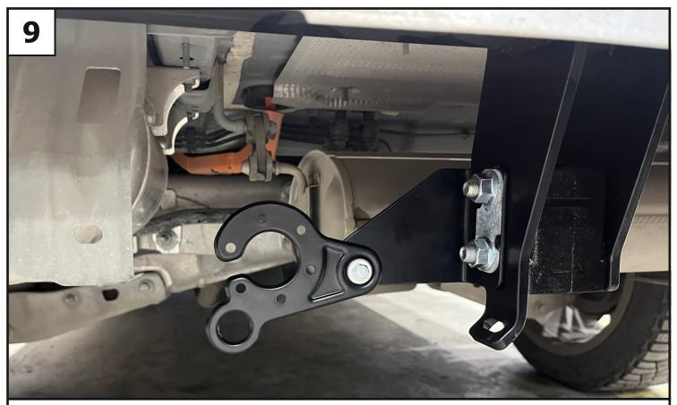
Установить кронштейн под розетку (3), закрепив с помощью болта М6х25 (7), шайб 6 увеличенных (15), шайб 6 полиамидных (16) и гайки М6 (12). Затянуть все резьбовые соединения: сначала ответную часть быстросъема с балкой, затем кронштейн под розетку с кронштейном. Моменты затяжки: М6=10 Нм; М12=81 Нм.
