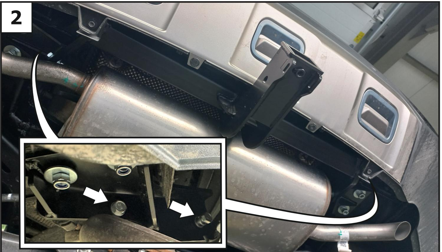
Прогнать резьбовые отверстия балки (1) с помощью метчика М12х1,25. Закрепить балку (1) к установленным кронштейнам с помощью болтов М12х1,25х40 (11), шайб 12 пружинных (18), шайб 12 (19) и гаек М12х1,25 (13). Затянуть все резьбовые соединения - сначала балку с кронштейнами, после - кронштейны к лонжеронам. Момент затяжки: М12= 81 Нм.
