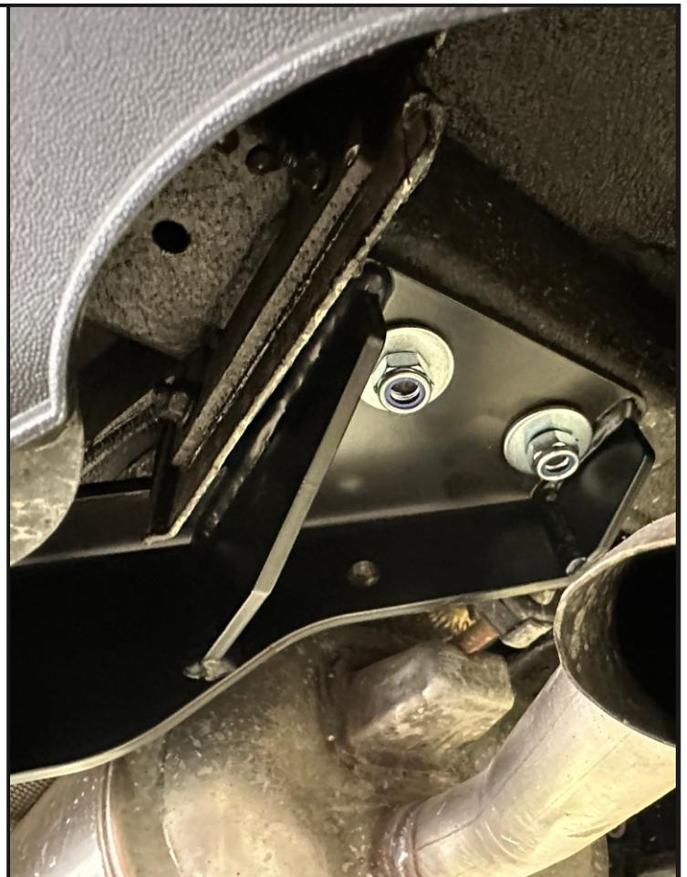
Установить левый (2) и правый (3) кронштейны, закрепив их к штатным шпилькам лонжеронов с помощью гаек 12 самоконтр. (14) и шайб 12 увел. (20).
