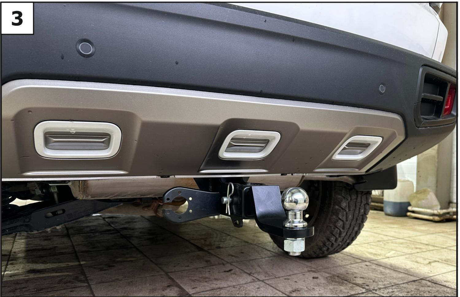
**Установить кронштейн под розетку (8) с помощью болта М8х80 (9), шайбы 8 пружинной (15), шайбы 8 (16), шайбы 8 увел. (17) и гайки М8 (12). Установить переходник (4), закрепив его с помощью штифта (6) и шплинта (7). Зафиксировать переходник болтом М10х20 (10) - фиксацию использовать без нагрузки. Установить на переходник шар (5), закрепив его гайкой М24 (21) и шайбой 24 пружинной (22). Затянуть резьбовые соединения. Момент затяжки: М8=25 Нм; М24=95 Нм.**
