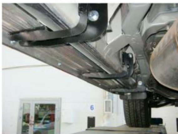
Рис. 5 Общий вид установленных кронштейнов
