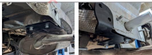
**ШАГ 4.** Установите балку ТСУ, используя штатные шпильки автомобиля, прикрутите штатными гайками M8, и, совместив отверстия в балке ТСУ с отверстиями в кронштейне, прикрутите болты M10 с гайками M10 через шайбы 10 и шайбы 10 гроверные.
