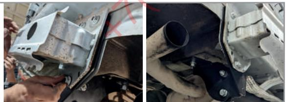
**ШАГ 7.** Установите съёмный шар в сборе и закрепите его пальцем гнутым гальванизированным со шплинтом пружинным игольчатом. Затяните шар ключом на 38 мм. Установите фиксирующий болт М10х20 снизу, **он используется для исключения технологических люфтов съёмного шара и только в ненагруженном состоянии! Перед сцепкой болт демонтировать!** Установите кронштейн розетки, как показано на схеме, используя гайку М10, шайбу 10 гроверную и шайбу 10. Установка завершена.
