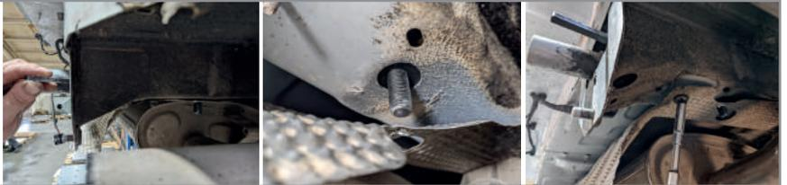
**ШАГ 4.** Установите закладную пластину с приварной шпилькой в технологическое отверстие лонжерона с левой стороны автомобиля так, чтобы шпилька прошла через отверстия в лонжероне и в тепловом отражателе. Установите левый и правый кронштейны на шпильки закладных деталей, установленных ранее, и на шпильки, фиксирующие положение штатной балки.
