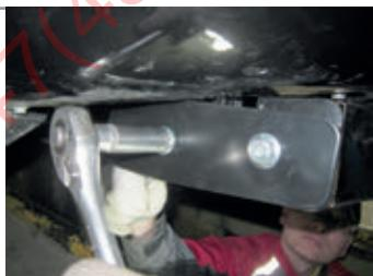
**ШАГ 6.** Установите съемный шар в сборе и закрепите его пальцем гнутым со шплинтом. Зафиксируйте съемный шар болтом M10x20 снизу. Затяните съемный шар с помощью ключа на 38 мм. Установка завершена.
