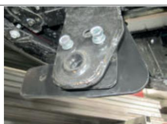
**ШАГ 4.** Установите балку ТСУ, совместив отверстия балки ТСУ с отверстиями боковых кронштейнов и соедините их с помощью болтов M12x1,25x45 через шайбы 12 и шайбы 12 гроверные, гайками M12x1,25. Соединения не затягивать.
