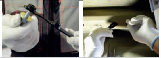
**ШАГ 2.** Выпрямите закладную, держа её за болт. Совместите отверстия в закладной и в лонжероне. Приложите кронштейн боковой к крайнему отверстию в лонжероне и закрепите кронштейн болтом M10x1,25x40. Выкрутите болт M10x1,25x30 из закладной, и, совместив остальные отверстия кронштейна, лонжерона и закладной, соедините детали болтами M10x1,25x30 через шайбы 10.
