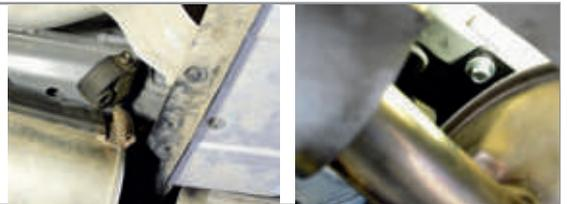
**ШАГ 4.** Для установки балки ТСУ, вставьте в буксирную петлю две шайбы 28x13 из комплекта поставки. Затем, совместив отверстие в центре балки с отверстиями в шайбах, закрепите всё с помощью болта M12x1,25x60 с гайкой M12x1,25 через две шайбы 12 с двух сторон и гровер 12. Затем соедините боковые кронштейны с балкой ТСУ болтами M10x1,25x40 через шайбы 10 и гайки M10.
