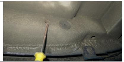
**ШАГ 3.** Для установки фаркопа совместите отверстия в балке ТСУ с резьбовыми отверстиями кузова автомобиля и соедините всё с помощью болтов M10, через шайбы 10 увеличенные и шайбы 10 гроверные.
