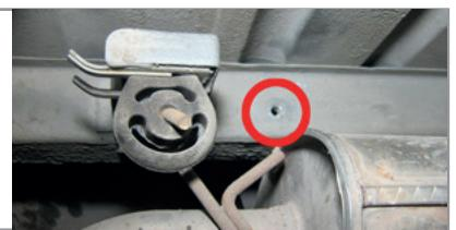
**ШАГ 2.** Отыщите два резьбовых отверстия в задней балке автомобиля, при необходимости прочистите отверстия от грязи.
