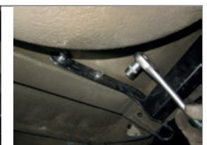
**ШАГ 5.** Установите кронштейн крепления электрической розетки.
