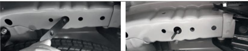
**ШАГ 2(2)** Установите кронштейн боковой с внутренней стороны лонжерона, гибком к центру авто и прикрутите его с помощью болтов M12x1,25x110, продетых сквозь лонжерон, гайками M12x1,25, через шайбы 12 и шайбы 12 гроверные.
