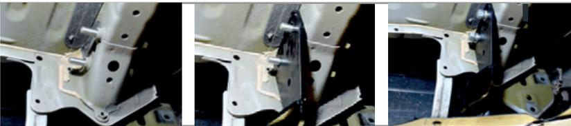
**ШАГ 3.** Установите пластину ( поз. R ) и прикрутите её к лонжерону с помощью болтов M10x1,25x40 (M8) через шайбы 10 (8) и к кронштейну с помощью болта M10x1,25x30 через шайбы 10 с двух сторон, шайбу 10 гроверную и гайку M10x1,25. Повторите шаги 2-3 для другой стороны.
