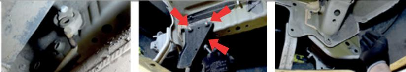
**ШАГ 2(1)** Для автомобилей после 2019 года выпуска. Вставьте закладную с гайками M8 в большое отверстие в лонжероне. Совместите гайки в закладной пластине с отверстиями в лонжероне.
