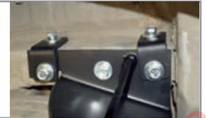
**ШАГ 4.** Установка правого кронштейна производится аналогично установке левого кронштейна, соединения не затягивайте.
