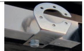
**ШАГ 7.** Затяните все резьбовые соединения. Установите глушитель на свои посадочные места. Установка завершена.
