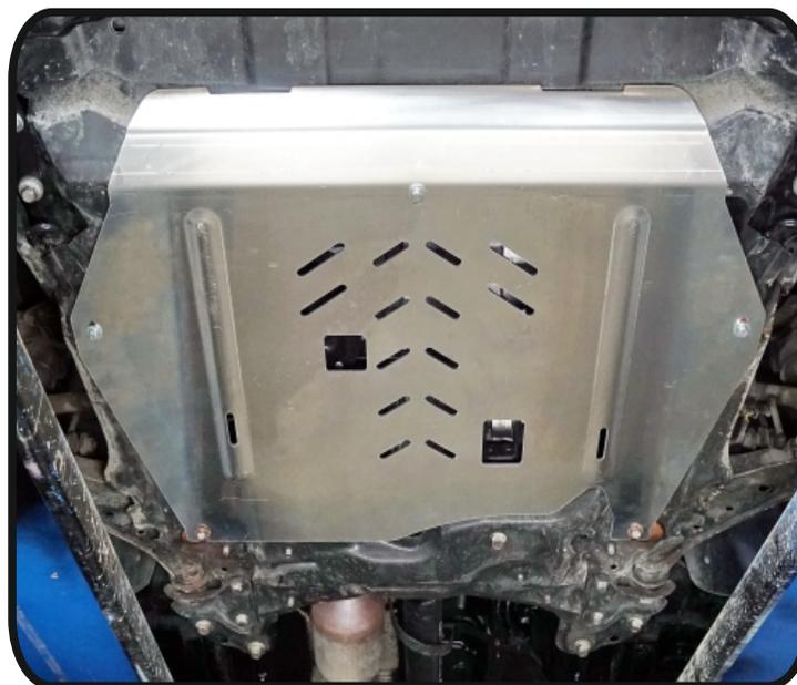
**Защита картера и КПП (алюминий) 4мм
