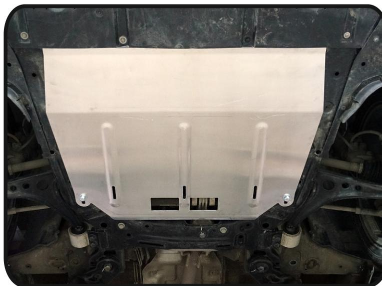
**Защита картера и КПП (алюминий) 4мм
