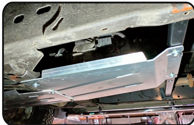
Защита раздаточной коробки (алюминий) 4мм арт.ZKTCC00581.
