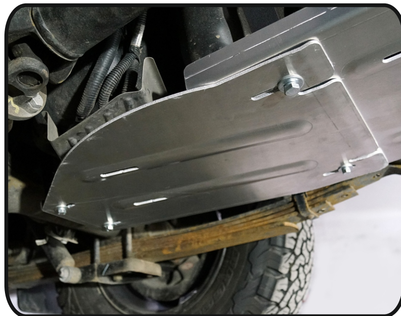
Защита емкости с AdBlue (алюминий) 4мм арт.ZKTCC00583.
