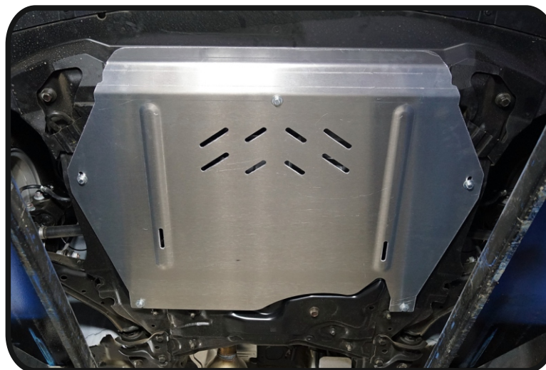
Защита картера и КПП (алюминий) 4мм арт.ZKTCC00602
