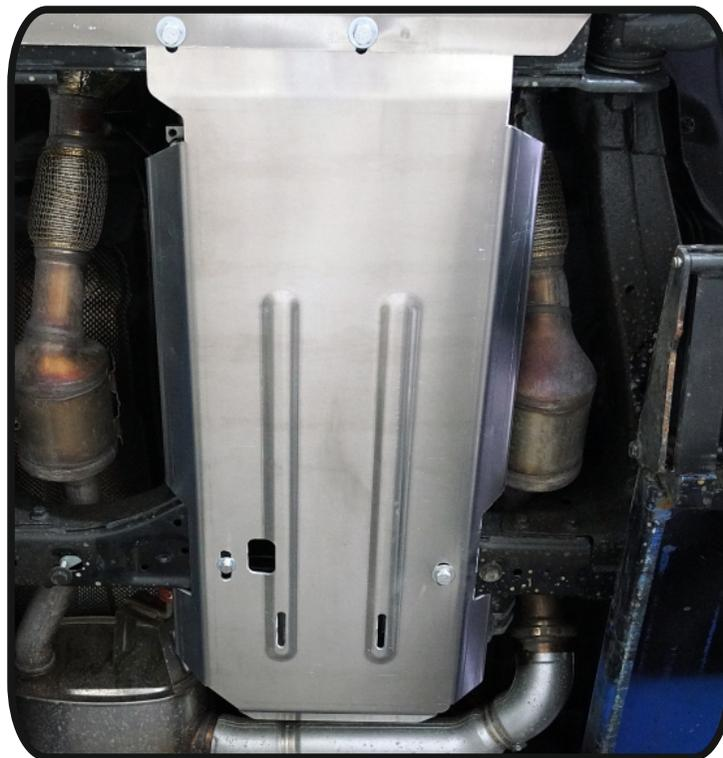
**Защита КПП и раздаточной коробки (алюминий) 4мм
