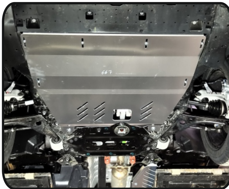
Защита картера и КПП (алюминий) 4 мм арт.ZKTCC00667.
