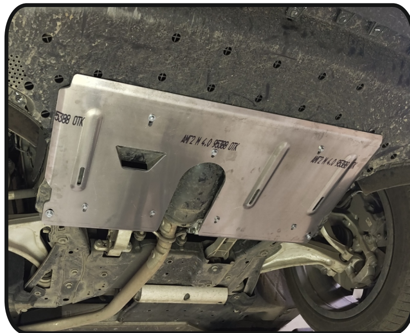
Защита картера (алюминий) 4 мм арт.ZKTCC00685.
