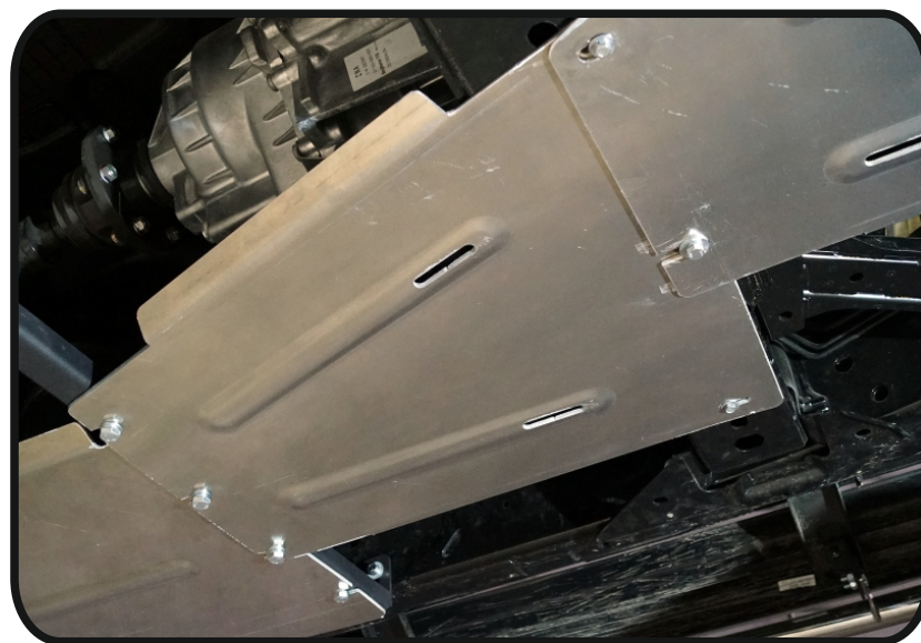
Защита раздаточной коробки (алюминий) 4 мм арт.ZKTCC00691.
