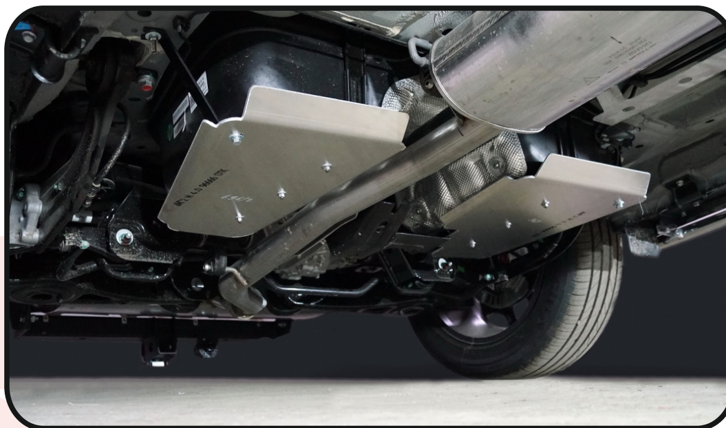
Защита бака (алюминий) 4 мм (2шт) арт. ZKTCC00696.
